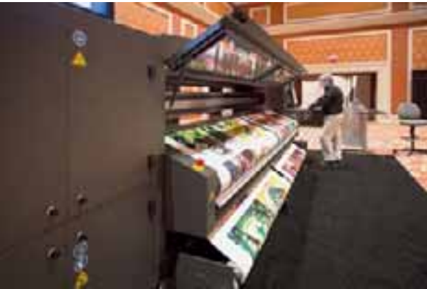
EFIs VUTEk GS3250LXr Pro ist ein kraftstrotzender LED-UV-Rollendrucker mit hochelastischen Tinten.
